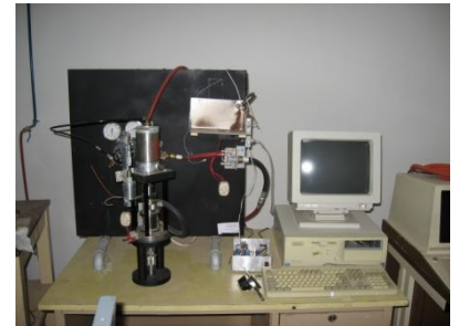
El sistema de presión para crear dislocaciones por medio de deformación plástica de cristales.
